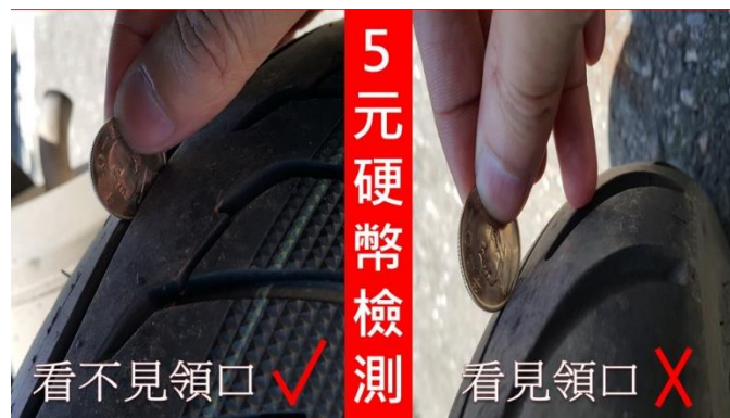
圖 5.3-10 機車輪胎磨耗指示點圖
